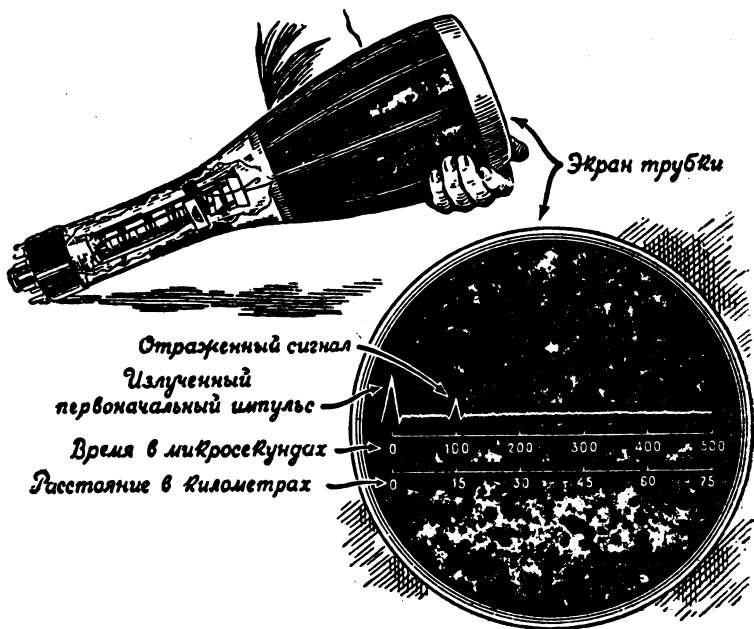
Рис. 80. Электронно-лучевая трубка и ее экран
