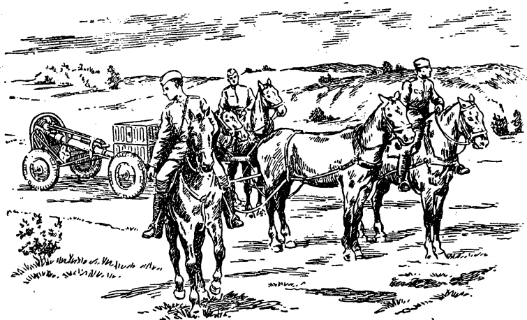
Рис. 13. 120-мм миномет на колесном ходу с передком, в котором уложено 20 мин. Перевозят его четыре лошади
